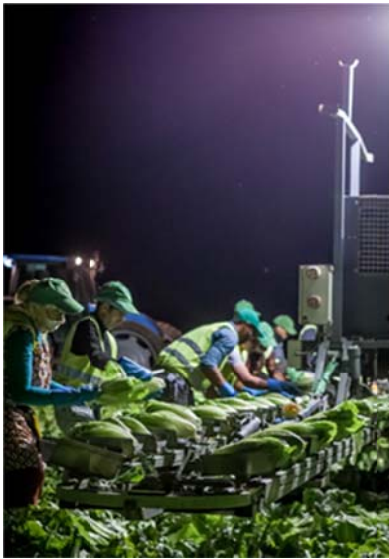
Recolección nocturna semi-automática de lechuga romana en Agromediterránea. Mejora la ergonomía de las personas, la frescura del producto y reduce la presencia de insectos.
