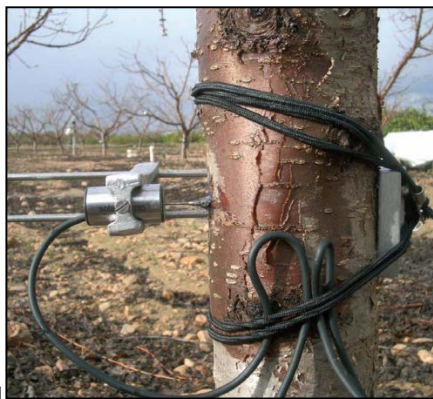
Medidas micrométricas de grosor de tronco utilizadas para el diagnóstico del déficit hídrico en árboles leñosos.
