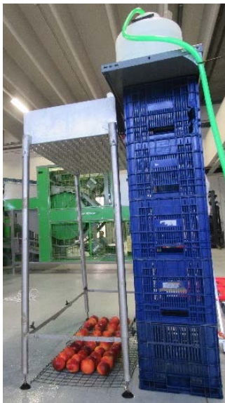
Figura 7. Muntatge per a la simulació de pluja en l'estudi de la dinàmica poblacional dels productes de biocontrol en la superfície de la fruita. El simulador consisteix en una caixa metàl·lica (100x50x20 cm) amb agulles hipodèrmiques a la base que generen un sistema de degoteig en funció de la pressió de la columna d'aigua continguda a la caixa.
